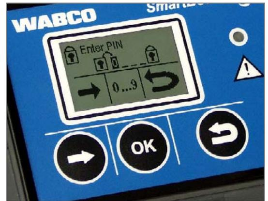
El Inmovilizador necesita un Modulador Trailer EBS E Premium de la versión 1.5 (producción a partir de la semana 50/2009) y un SmartBoard (a partir de la semana 49/2009). Una electroválvula conectada a un Power-GIO libre asume el control de la cámara de muelle de los actuadores de freno. Adicionalmente se puede activar una señal acústica que sonará como alarma cuando se manipulen los frenos.
