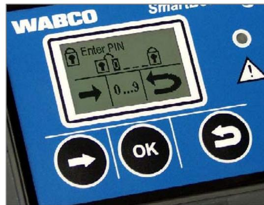
L'immobiliseur requiert un modulateur Premium EBS E pour véhicules remorqués dans la version 1.5 (à partir de la 50ème semaine de fabrication de 2009) et un SmartBoard (à partir de la 49ème semaine de fabrication de 2009). Une électrovalve installée sur un raccord GIO Power libre se charge de piloter les cylindres à ressort. Il est en outre possible d'activer un avertisseur sonore à air qui donnera l'alerte en cas de manipulation du frein.
