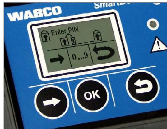
L'immobilizer necessita di un modulatore Trailer EBS E premium, versione 1.5 (dalla settimana di produzione 50/2009) e di uno SmartBoard (dalla settimana di produzione 49/2009). Un'elettrovalvola connessa ad un collegamento libero GIO assume il controllo dei cilindri freno a molla. Può inoltre essere attivato un segnale acustico, al fine di creare un allarme in caso di manipolazione dei freni.
