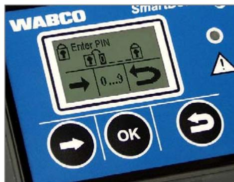
Для активации и дезактивации иммобилайзера владелец автомобиля задает PIN-код и сообщает его водителю / водителям. Так, например, достаточно по телефону сообщить PIN-код, чтобы подцепить и через какое-то время увезти снятый прицеп другим тягачом.
