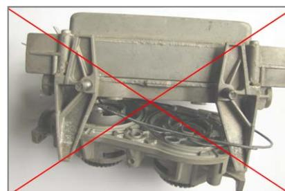
Мы не принимаем части, поврежденные использованием не по назначению или во время разборки (хранимые механические повреждения в крышке, портах или соединителях).
