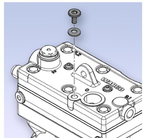
Anschluss 4 des Kompressors verschließen
