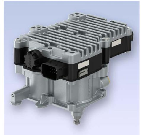
*AMT de Daimler, cilindro de dos posiciones (GASSE)*
