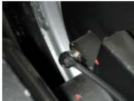
Abb. 15 Einbaulage des Geschwindigkeitssensor
