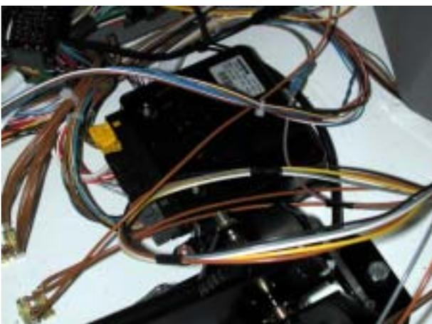
Abb. 13 Einbaulage der ECU im Multicar im Bereich des Mittelunnels
