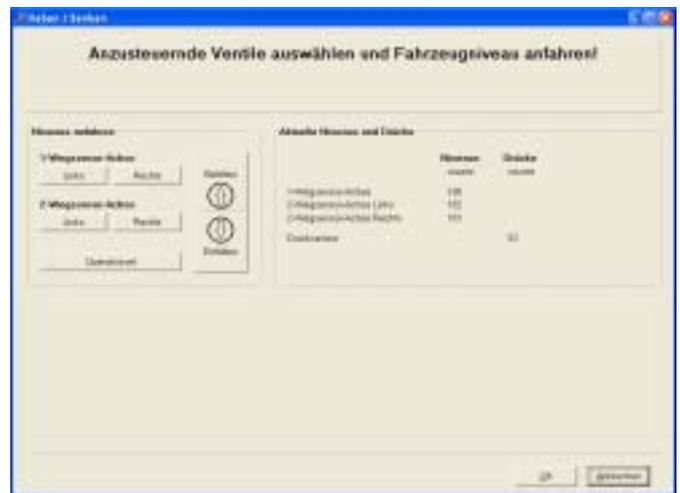
Im Menü „Ansteuerung“ können die Luftfederbälge der Achsen ausgewählt sowie be- und entlüftet werden. Dabei werden die Werte der angefahrenen Niveaus und Drücke angezeigt.
