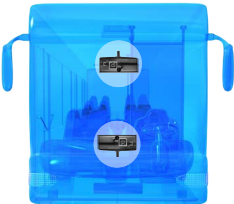
Optionale Kamera-Montagepositionen – oben oder unten mit 180° Panorama-Rotation
