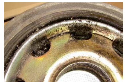
Abb. 2: Trockenmittelkartusche mit Koaleszenzfilter nach 60.000 km
