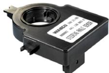
Der Lenkradwinkelsensor ist an der Lenksäule des Fahrzeugs installiert und stellt einen Messwert des Absolutwinkels (Position) des Lenkrads bereit. Dies umfasst die Möglichkeit, durch die Sensorkalibrierung die Nullstellung des Lenkrads (Mittelposition) zu identifizieren.
