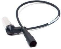
Über ein Polrad ermittelt der Drehzahlsensor permanent die aktuelle Radgeschwindigkeit und leitet diese Daten an die EBS-Elektronik weiter, die anhand von Referenzwerten die aktuelle Geschwindigkeit ermittelt. Bei Abweichungen vom Normalzustand greift das System regulierend in die Brems- und Motorsteuerung ein.
