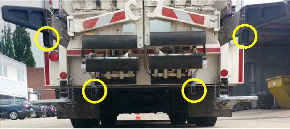
Bei diesem Fahrzeug wurden vier Sensoren in zwei Ebenen verbaut: in der unteren Ebene zwei Sensoren, und zwar unterhalb des Lifters in Fahrstellung, sowie als obere Ebene zwei Sensoren direkt unter den Tonnenabweisern. Alle Sensoren wurden stehend verbaut. Somit werden hier Objekte in zwei horizontalen Ebenen erkannt.
