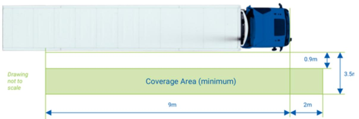
Ein Warnsignal wird an den Fahrer übermittelt, damit er eine Kollision des Fahrzeugs mit dem ungeschützten Verkehrsteilnehmer (VRU) verhindern kann. Dies ermöglicht dem Fahrer eine schnelle Reaktion und ein rechtzeitiges Bremsen.
