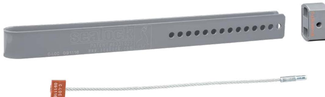
One Way ist ein schlüsselloses Einweg-Verriegelungs- und Versiegelungssystem, für das ein Stahlkabel und ein Riegel erforderlich sind, die zur Öffnung der Tür physisch durchtrennt werden. One Way ist eine einfache und effektive Sicherheitslösung, die manipulationssicher und mit einfach zu erkennenden Seriennummern ausgestattet ist.
