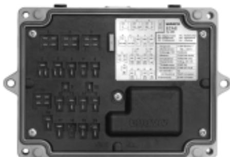
Il est également possible de raccorder en série à l'EBS pour véhicules remorqués un dispositif électronique de suspension pneumatique ECAS. La commande et la surveillance électriques s'opèrent par l'intermédiaire du modulateur de la remorque. Si un ECAS est monté, une batterie peut être raccordée au modulateur EBS (uniquement 480 102 014 0), afin que l'ECAS puisse fonctionner sans tracteur attelé.
