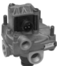
La valve relais ABS utilisée dans les systèmes de freinage conventionnels et une double valve d'arrêt sont intégrées au système de freinage électro-pneumatique comme organe de commande pour le contrôle des pressions de freinage d'un essieu suiveur dans le cas des semi-remorques. La commande et la surveillance électriques s'opèrent par l'intermédiaire du modulateur de la remorque.
