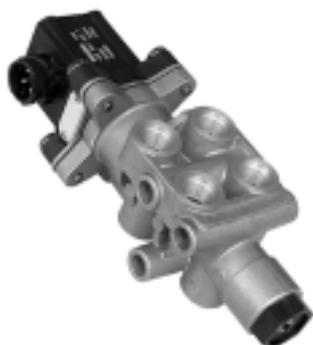
La valve essieu relevable à un circuit permet à l'EBS D pour véhicules remorqués de gérer automatiquement un essieu relevable en fonction de la charge par essieu. La commande et la surveillance électriques s'opèrent par l'intermédiaire du modulateur de la remorque.
