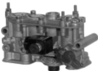
Grâce à la valve de relevage d'essieu à deux circuits, il est possible de commander avec l'EBS Remorque jusqu'à deux essieux relevables automatiquement en fonction de la charge essieu. La commande et la surveillance électriques s'opèrent par l'intermédiaire du modulateur de la remorque.
