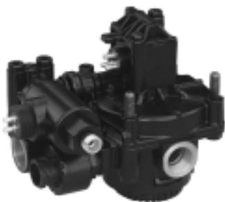
Avec l'EBS C pour véhicules remorqués, la valve relais EBS est utilisée comme organe de commande pour le contrôle des pressions de freinage de l'essieu avant dans le cas des remorques avant-train ou d'un essieu additionnel dans le cas des semi-remorques.
