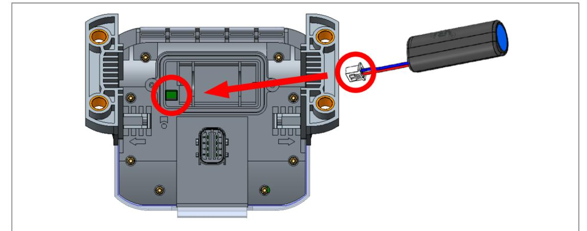
5. En respectant la polarité, enfoncez le connecteur de la pile de rechange dans l'emplacement prévu à cet effet et insérez la pile de remplacement.
