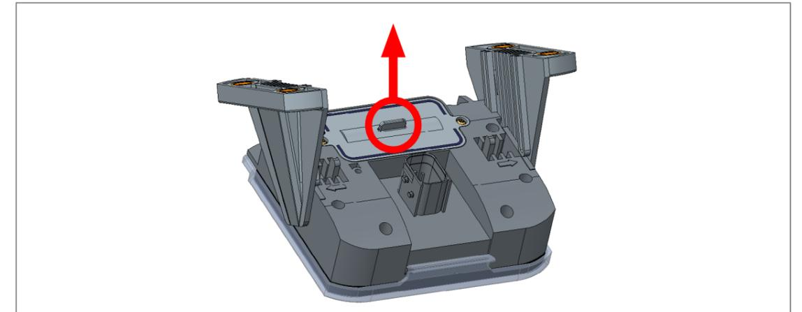
3. Retirer le couvercle du compartiment à pile avec une pince plate.
