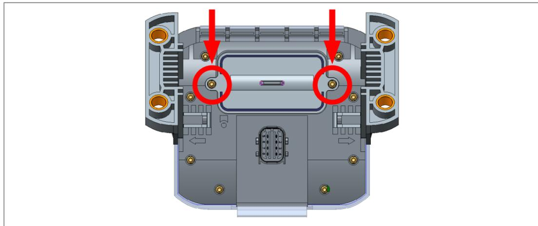
2. Desserrer les deux vis Torx® du couvercle du compartiment à pile.
