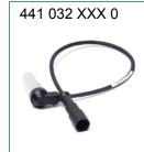
Attraverso una ruota fonica il sensore di velocità trasmette in modo continuo la velocità ruote attuale e invia questi dati all'EBS, che in base a valori di riferimento emette la velocità attuale. In caso di variazione dalla condizione normale il sistema interviene per regolare il controllo di frenata e la gestione del motore.
