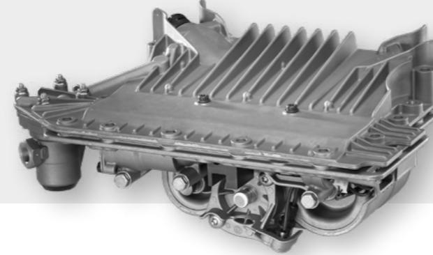
Aktuator mjenjača (GS 3.X) upotrebljava se na komercijalnim vozilima s maksimalno 16 brzina. Napravljen je za brzu promjenu brzina pametno se prilagođavajući odgovarajućim uvjetima vožnje. Proizvodni program GS čini pneumatski pokretač s elektroničkim upravljanjem s četiri cilindra (ulazni, raspona, brzine- i razdjelni) i ugrađenom elektroničkom upravljačkom jedinicom (EJ) za promjenu brzina za AMT.
