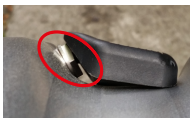
Montarea incorectă a senzorului intern
