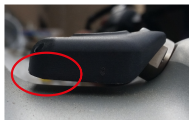
Montarea incorectă a senzorului intern
