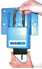
– Stecken Sie den Bügel durch die Öffnungen der Verriegelung.
