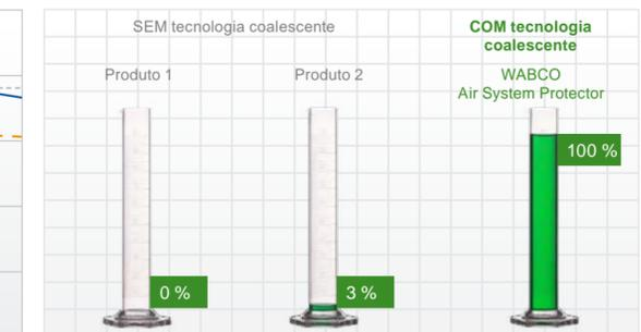
Condições de teste: compressor de dois cilindros de 704 cm<sup>3</sup> a temperaturas elevadas, 12,5 bar e 50% de ciclo de serviço; cálculo baseado na medição de aerossóis a jusante do secador de ar
