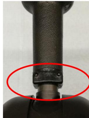
Im eingebauten Zustand kann das WABCO-Handbremsventil an zwei Metallstiften im unteren Teil des Griiffs identifiziert werden, siehe Abbildungen 2 und 3.
