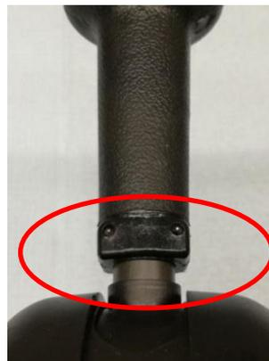
Assemblé, le robinet de frein à main WABCO peut être identifié par deux goupilles métalliques dans la partie inférieure de la poignée, comme indiqué sur les photos 2 et 3.
