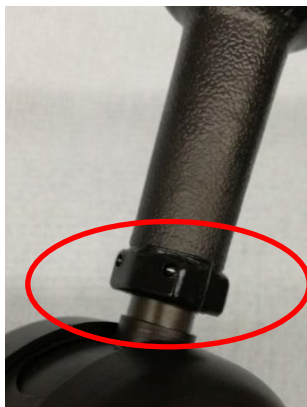
Figura 2: Alavanca manual com dois pinos
