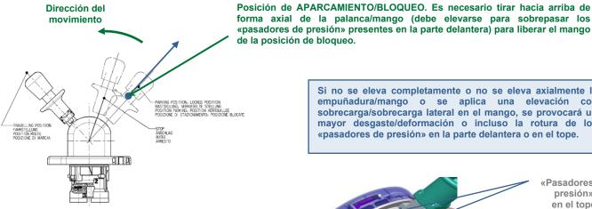
Si no se eleva completamente o no se eleva axialmente la empuñadura/mango o se aplica una elevación con sobrecarga/sobrecarga lateral en el mango, se provocará un mayor desgaste/deformación o incluso la rotura de los «pasadores de presión» en la parte delantera o en el tope.
