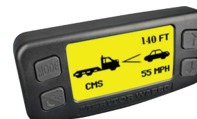
Alerte associée à la distance intervéhiculaire : régulateur de vitesse et d'espacement réglé
