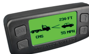
Régulateur de vitesse non réglé Véhicule à l'avant détecté
