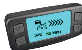
Régulateur de vitesse réglé Aucun véhicule à l'avant détecté
